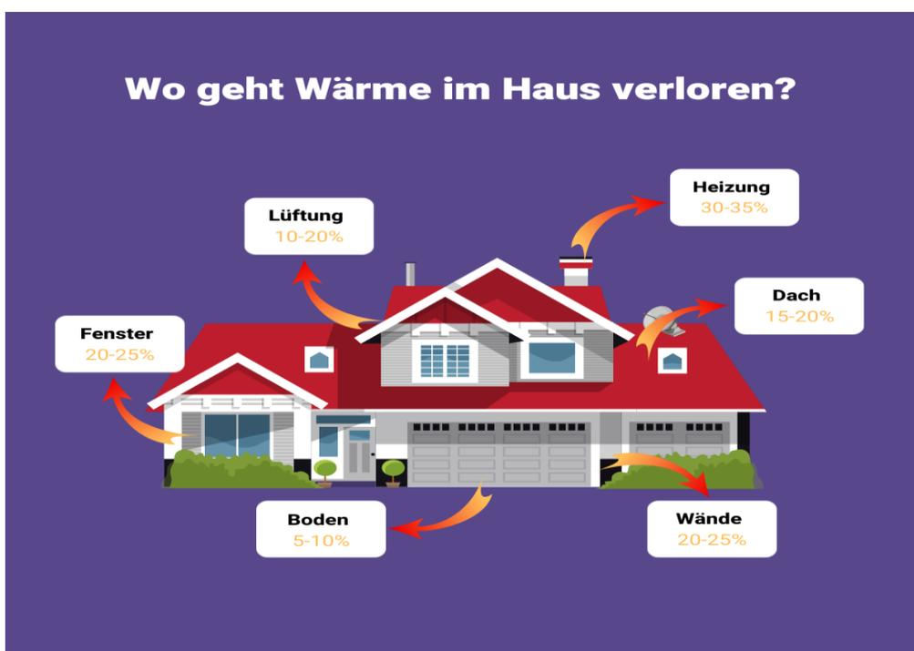
Abbildung 15: Energieverluste bei der Wärmeversorgung bestehender Wohngebäude.<sup>5</sup>
