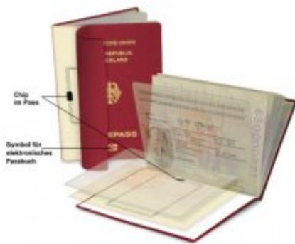
_ Das Bild zeigt den elektronischen Reisepass aufgeschnitten.
